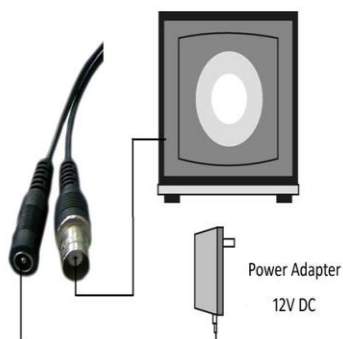
Рис. 5.1. Коммутация разъемов видеокамеры
