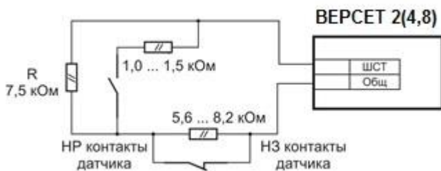
Рис.7. Схема включения технологических датчиков в ШСТ. НР – нормально разомкнутые контакты датчика НЗ – нормально замкнутые контакты датчика
