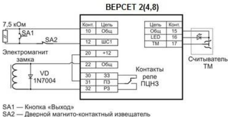
Рис.8. Схема организации Точки доступа.
